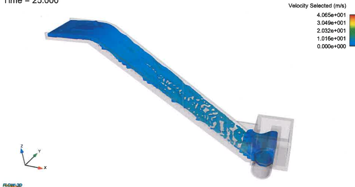
Figura 13 – Funcionamiento del derramadero y disipador de impacto
