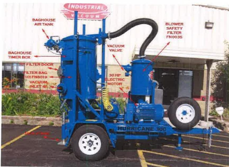
Las aspiradoras son equipos muy versátiles y utilizados en diferentes tipos de industrias para la recolección de residuos y/o derrames generados por los diferentes procesos de producción, estas funcionan gracias a un motor. Cuando el motor se enciende, este acciona un ventilador que, a su vez, reduce la presión del aire en su interior. En ese momento, se crea un vacío parcial obligando a entrar al aire a través de la manguera de la aspiradora.
