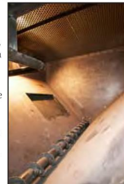
Caja noqueadora con gusano de retorno de finos.
