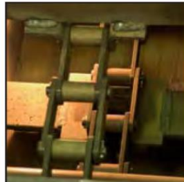
Recubrimiento de acero al carburo de cromo y cadena de arrastre de trabajo pesado.
