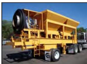
Chasis independiente opcional para el sistema de agregados.
