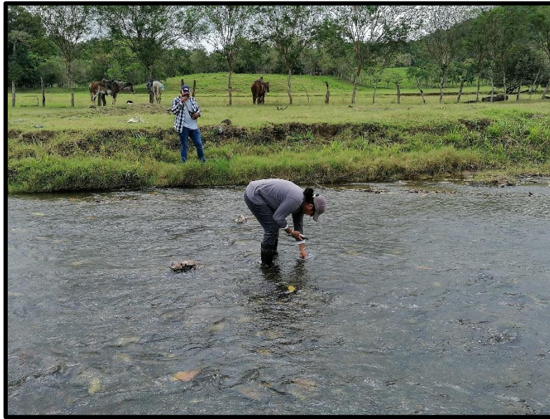
Figura 30. Toma de una muestra de las aguas del Río San Bartolo para analizar sus características fisicoquímicas.
