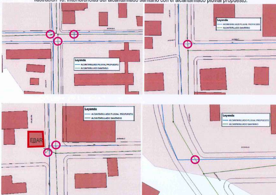
Ilustración 18. Interferencias del alcantarillado sanitario con el alcantarillado pluvial propuesto.
