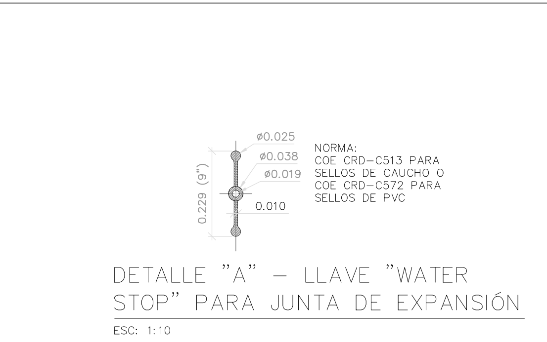
DETALLE "A" - LLAVE "WATER STOP" PARA JUNTA DE EXPANSION ESC: 1:10
