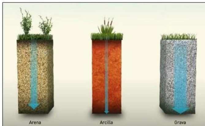
Figura 15. Puede apreciarse de conformidad con el respectivo esquema del vector de flujo en cada suelo, la importancia de la permeabilidad en la infiltración.
