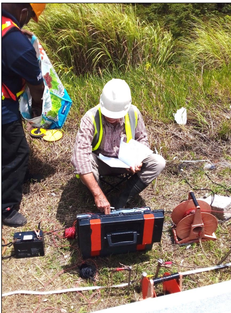
Figura 20. Labores de captura de datos geoelectricos del SEV-4 localizado sobre el hombro de la carretera Gonzalillo -Pedregal.
