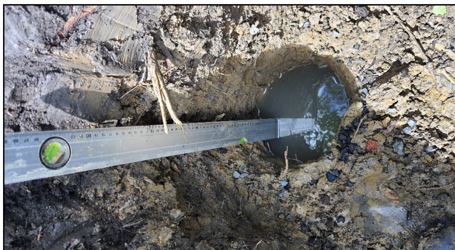
Foto 2. Realización de la prueba de percolación.
