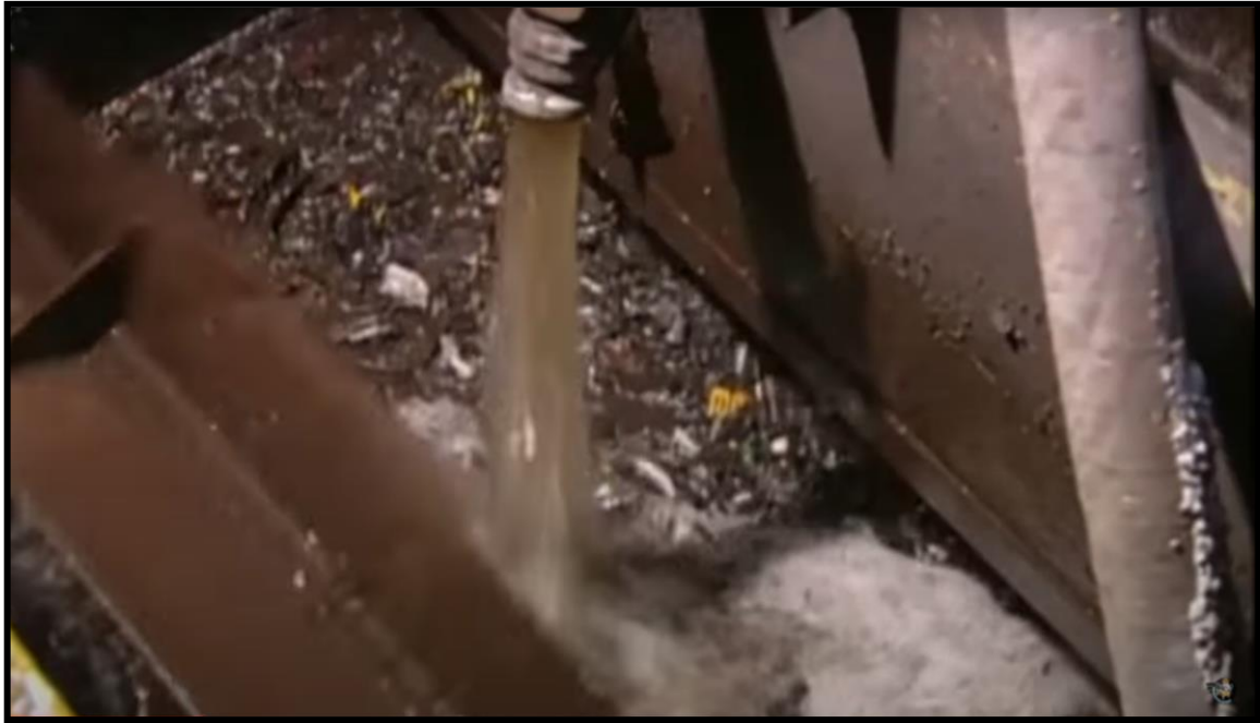
Figura 5.15. En el agua flotan los otros materiales, que se lavan, secan y son recolectados.
