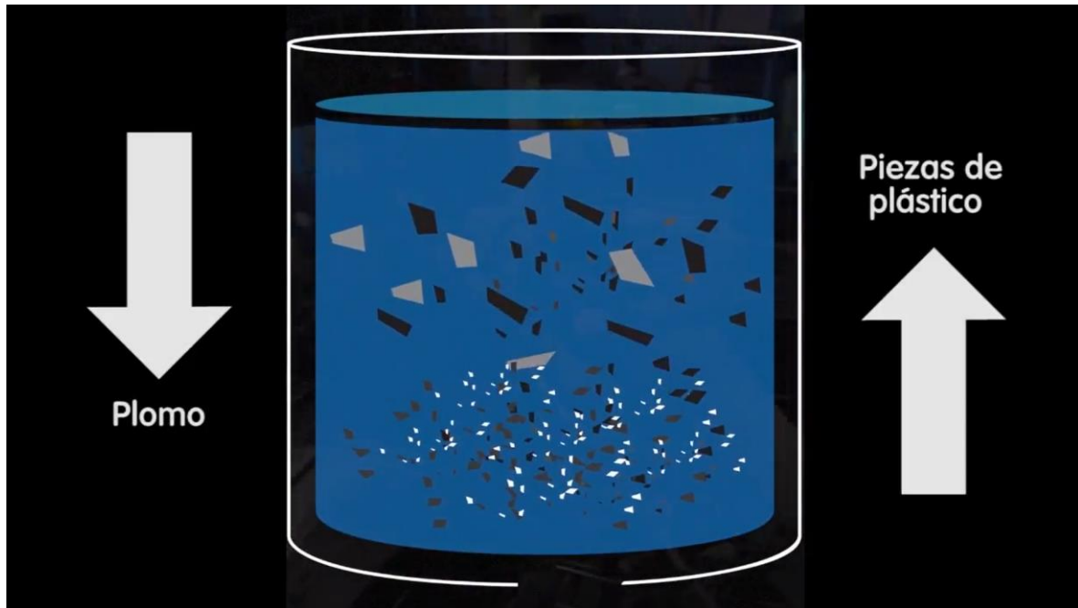
Figura 5.29. El plomo se separa del resto de los componentes y se deposita en el fondo.
