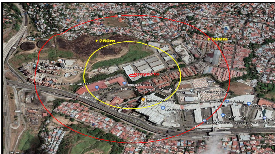
Figura 5.21. Radios de alcance ambiental del proyecto: Amarillo de mayor riesgo 250m y de protección: Rojo: 500 m. Se establece esta zona de riesgo mayor basados en la discrecionalidad y tomando en cuenta el tipo de material a manejar, disminuyendo este riesgo el hecho de estar en una zona industrial y rodeada por esta.
