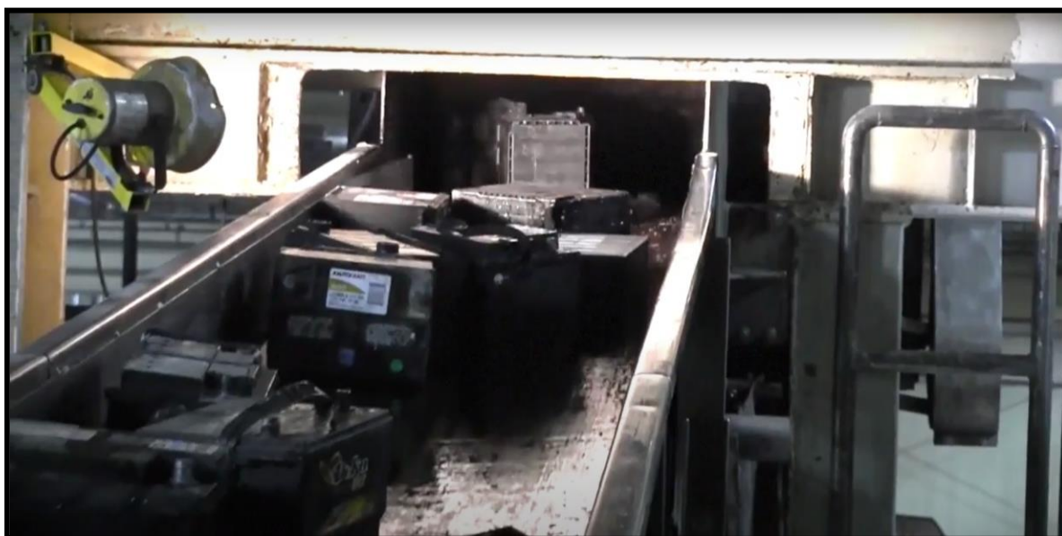
Figura 5.26. Proceso de trituración de las baterías.
