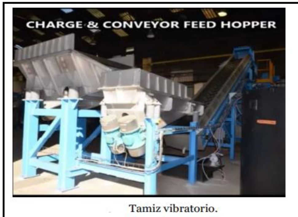
Figura 5.42. Vista ilustrativa del tamiz vibratorio.
