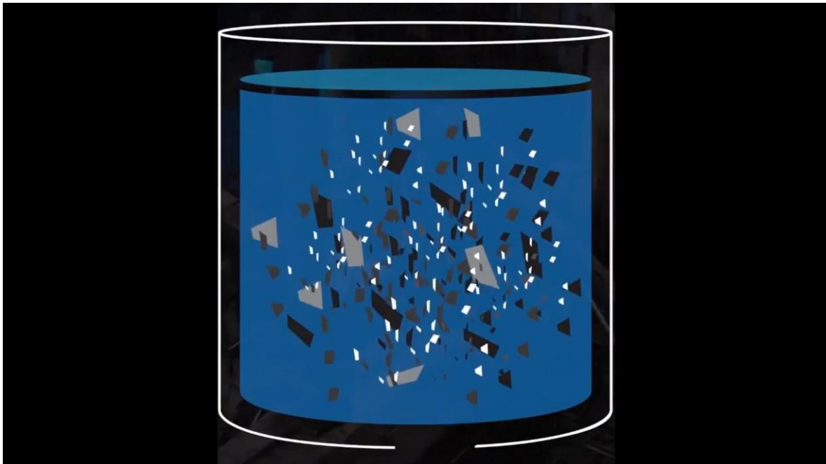
Figura 5.28. Componentes de la batería inmersos en el tanque durante el lavado.
