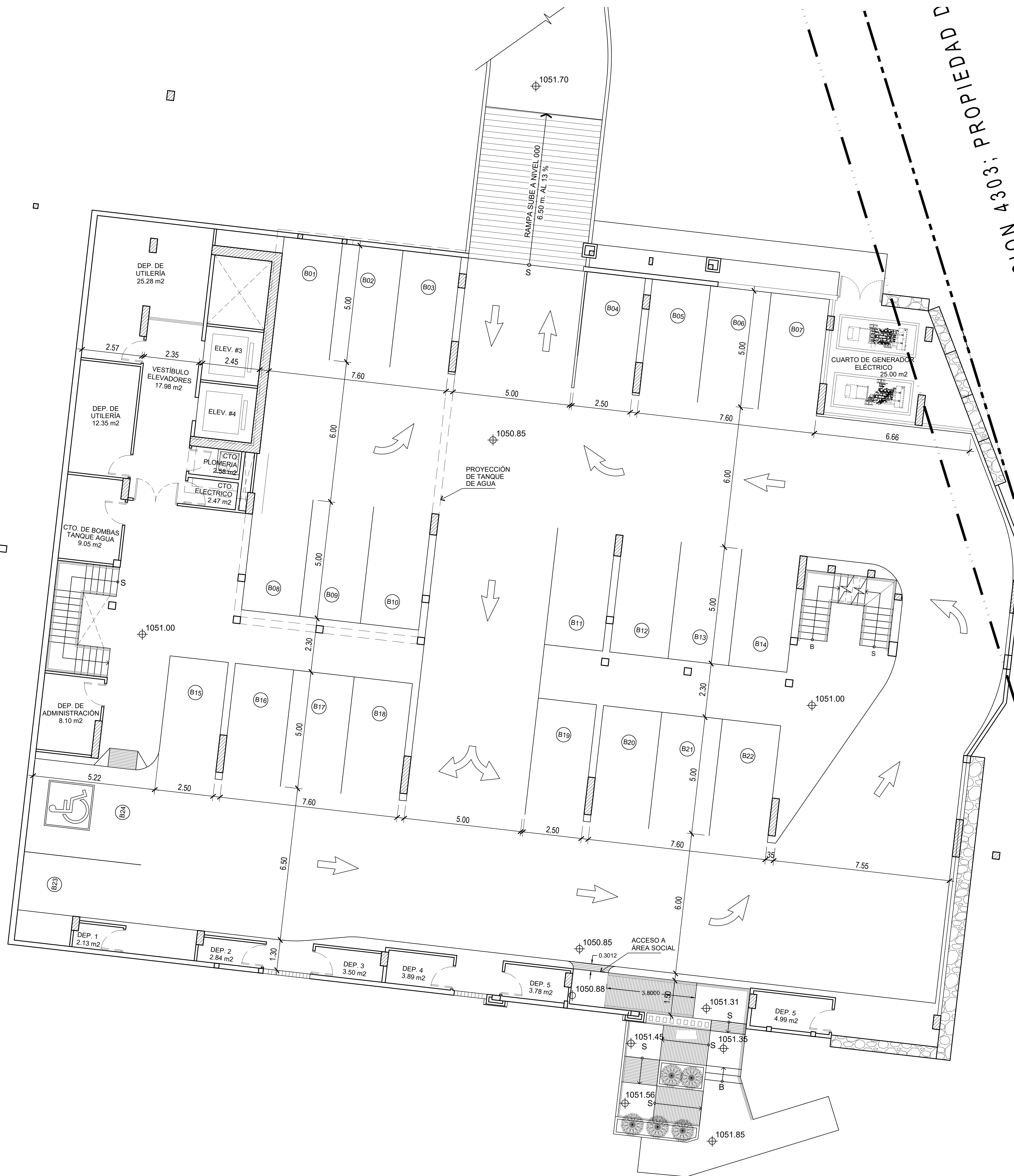
PLANTA ARQUITECTÓNICA NIVEL -100 (SÓTANO) - ESTACIONAMIENTOS DE EDIFICIO "B" ESCALA 1:100
