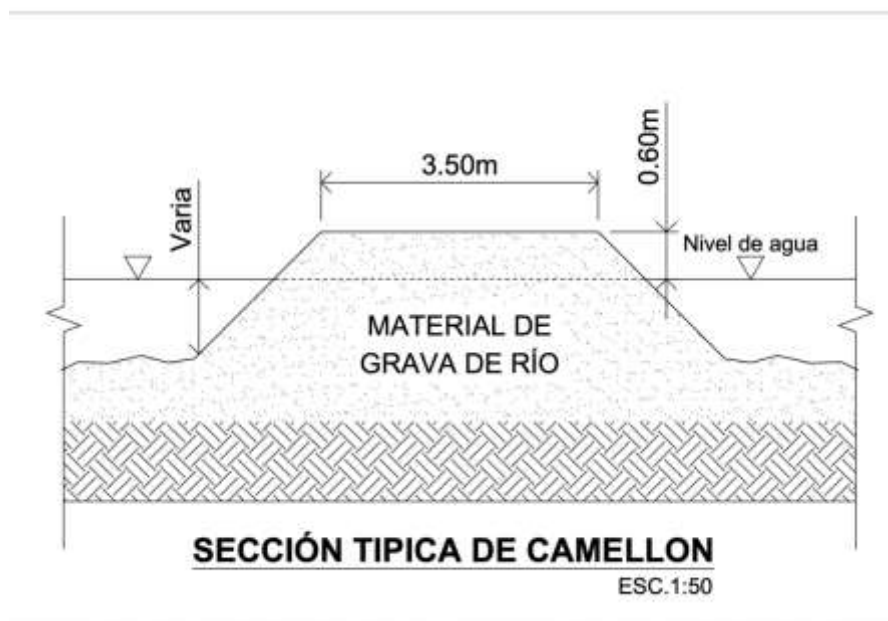
Ilustración No. 1. Sección típica de camellón
