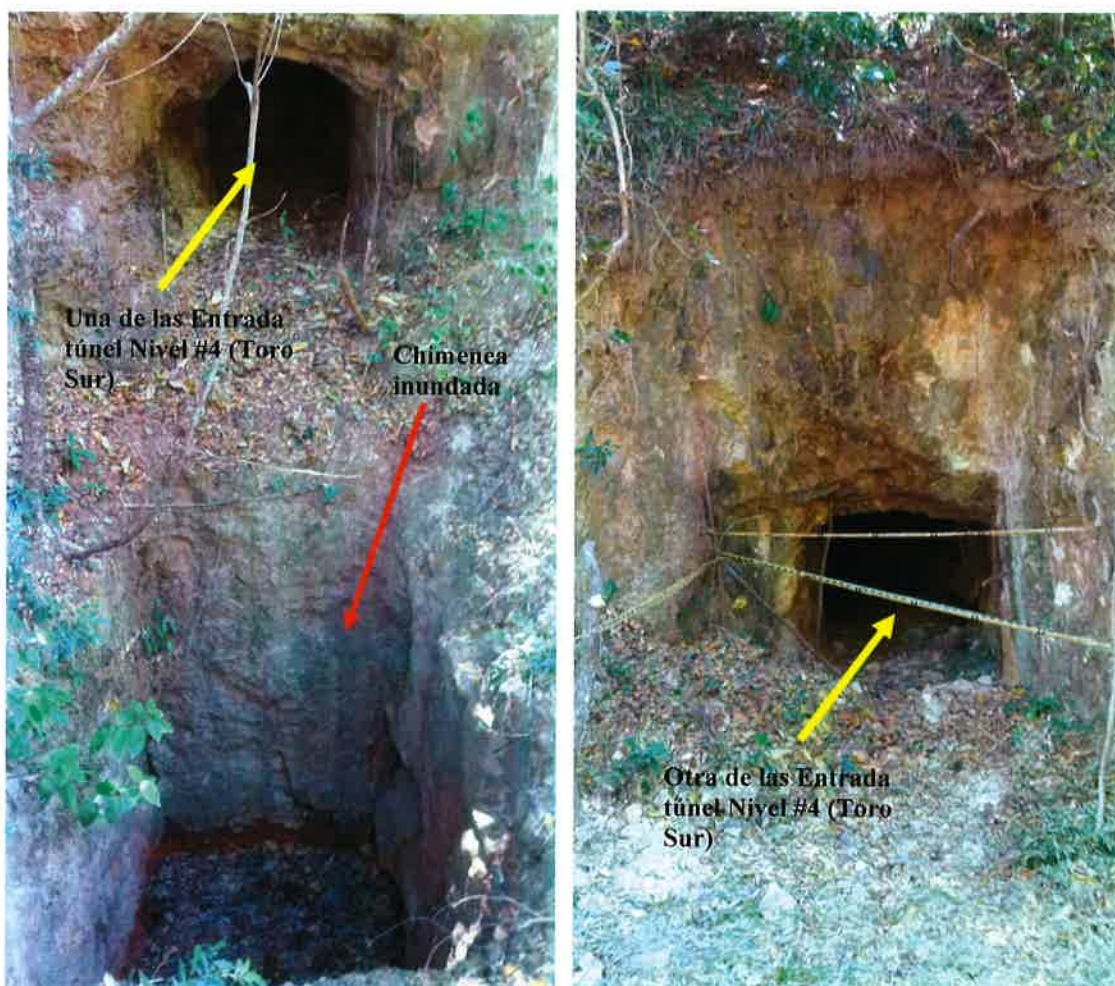
Foto N°6. Vistas más cercana de las entradas al túnel Nivel # 4 (conocido como Toro Sur), se aprecia una chimenea inundada que conduce a los niveles 5 y 6, y en la otra entrada al túnel.
