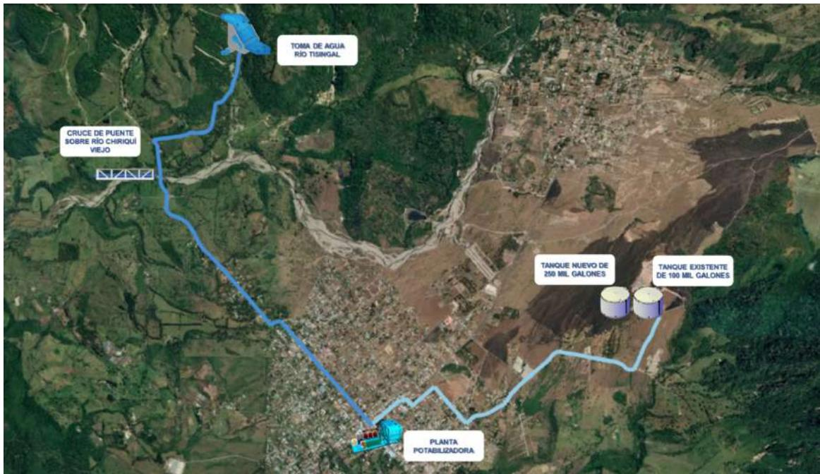
Figura 3: Principales Componentes del Estudio, Diseño y Construcción de Obras para la Rehabilitación del Sistema de Acueducto de la Comunidad de Volcán
