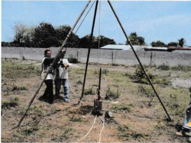
PRUEBA DE PENETRACION HOYO #2, EN LA FOTO POSTERIOR EL TIPO DE MATERIAL EXTRAIDO
