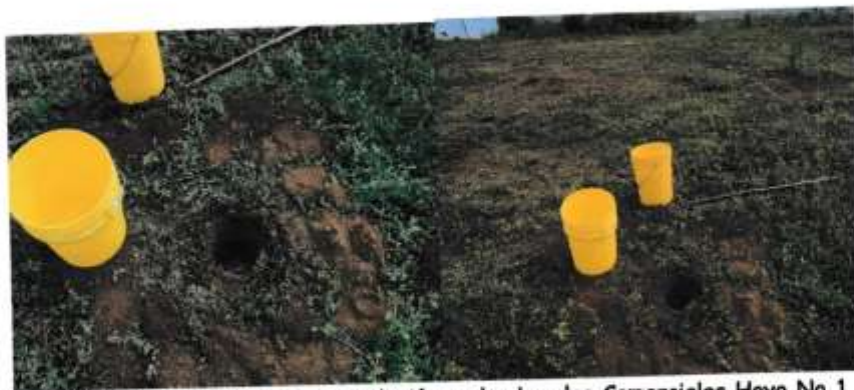
Inicio de las pruebas de percolación en los Locales Comerciales Hoyo No.1
