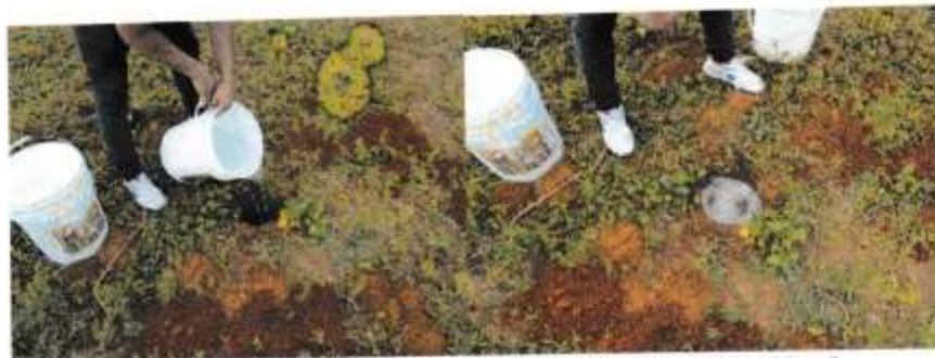
Prueba de percolación en los Locales Comerciales Hoyo No. 2
