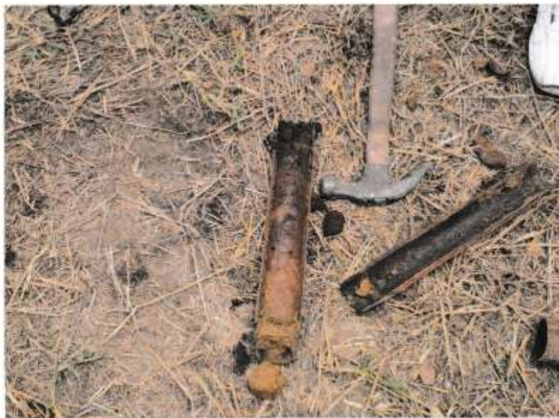
PRUEBA DE PENETRACION HOYO #1, EN LA FOTO POSTERIOR EL TIPO DE MATERIAL EXTRAIDO
