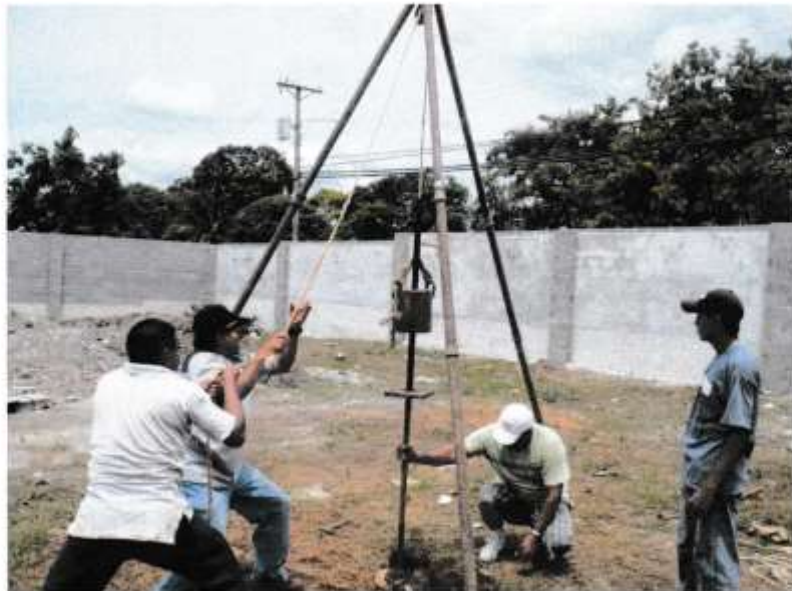
PRUEBA DE PENETRACION HOYO #1, EN LA FOTO POSTERIOR EL TIPO DE MATERIAL EXTRAIDO
