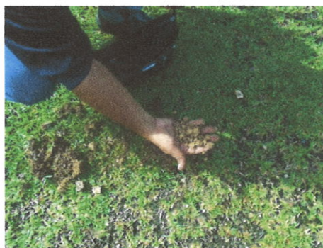
Fotos N°7, 8, 9, 10, 11, 12 Las prueba de sondeos constatan el nivel de relleno sobre el cual se construyó la Infraestructura
