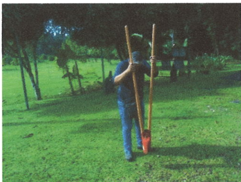
Fotos N°7, 8, 9, 10, 11, 12 Las prueba de sondeos constatan el nivel de relleno sobre el cual se construyó la Infraestructura
