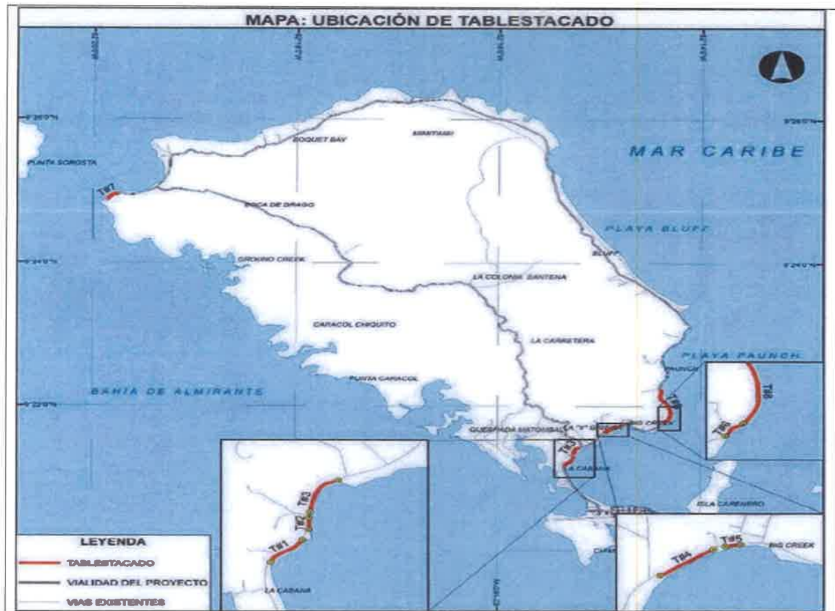
Imagen 3. Se observan los ocho puntos críticos de la vialidad que presentan erosión y se colocará tablaestacado de PVC.
