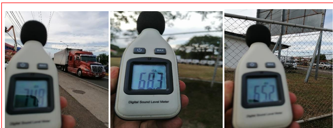
FIGURA 5 – Vistas que ilustran el registro de las mediciones de ruido efectuadas. (Sáez 2021)
