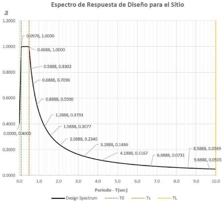
Figura 1: Espectro Sísmico de Diseño.
