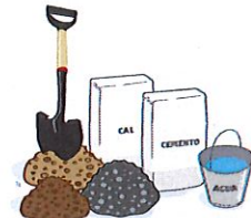
3. Preparación de la mezcla para la plantilla de base.
