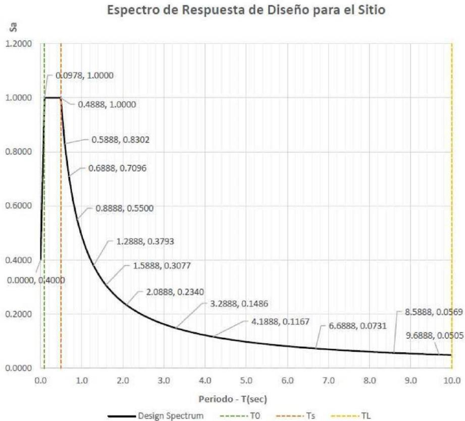
Figura 1: Espectro Sísmico de Diseño.
