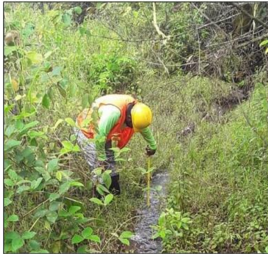
Figura 11. Medición de la manifestación de agua en su parte superior donde termina el camino de acceso partiendo de una zona de empozamientos. Fuente: Equipo Consultor, 2021.
