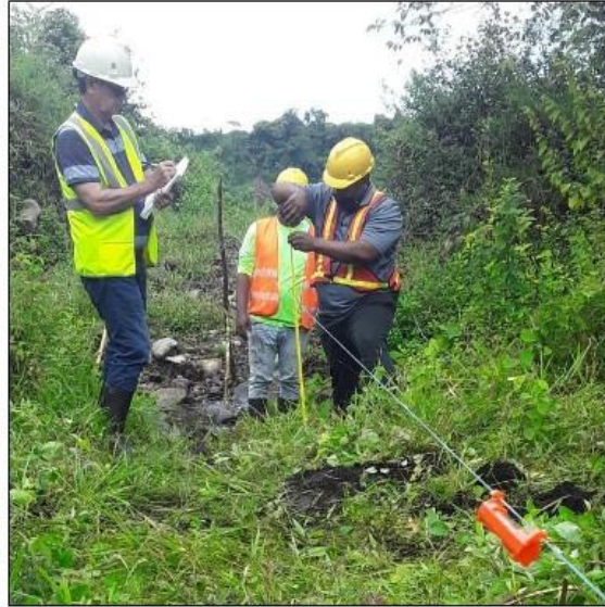
Figura 13. Registro de niveles freáticos en hoyos excavados que convergen alineados al drenaje para cálculos hidrogeológicos. Fuente: Equipo Consultor 2021.
