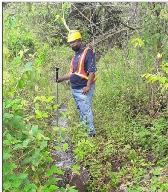
Figura 17. Aforo de la fuente superficial con el uso de molinete de tipo digital. Fuente: Equipo Consultor 2021.
