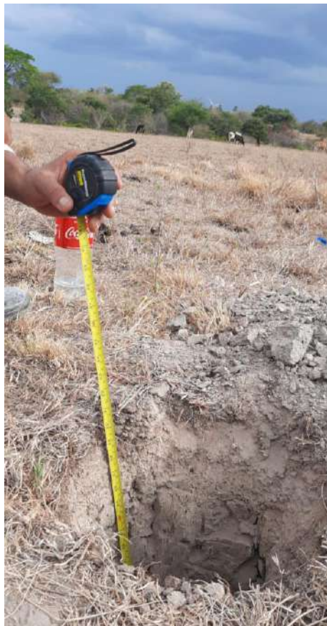
Figura 14 -Ejecución de ensayo de percolación 3
