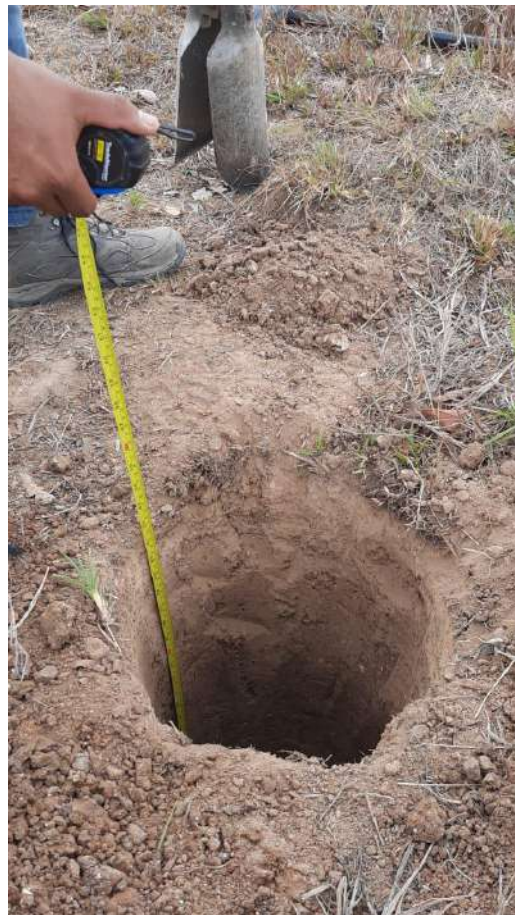
Figura 15 -Ejecución de ensayo de percolación 13
