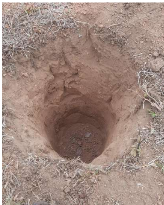
Figura 13 -Ejecución de ensayo de percolación 15
