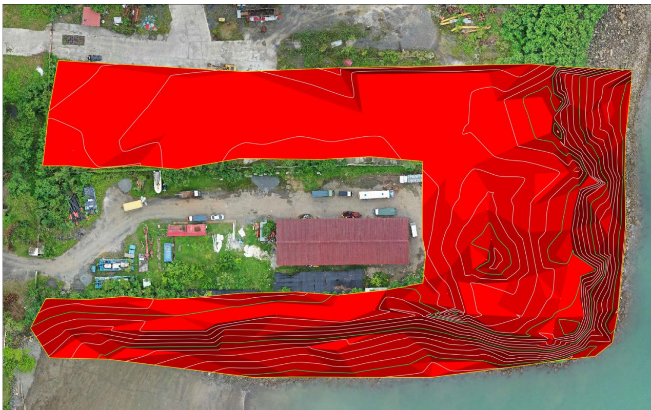
Figura 15: Superficie Pelican Terminal - Curvas de Nivel 0.50 m.
