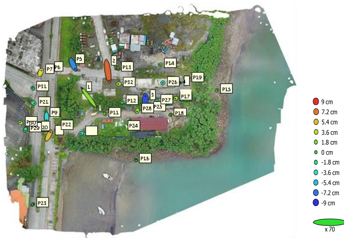
Figura 13: Posiciones de puntos de apoyos y estimaciones de errores.
