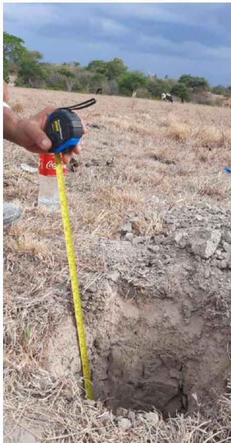
Figura 14 -Ejecución de ensayo de percolación 3
