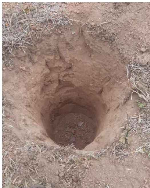
Figura 13 -Ejecución de ensayo de percolación 15
