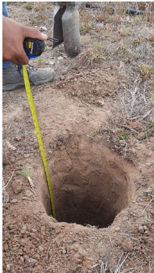
Figura 15 -Ejecución de ensayo de percolación 13
