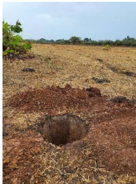
Ensayo de percolación
