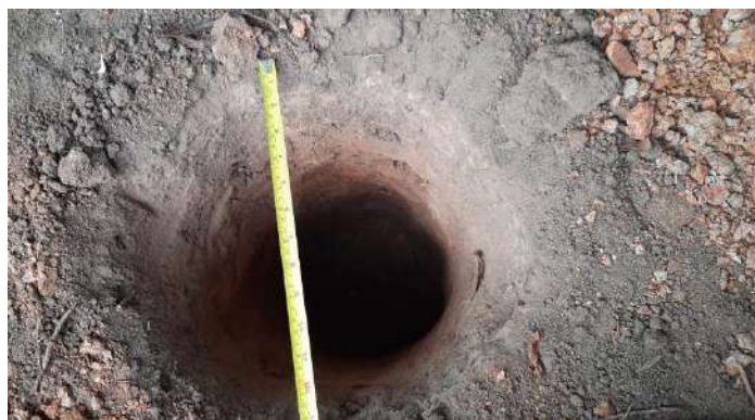
Figura 12 -Ejecución de ensayo de percolación 1
