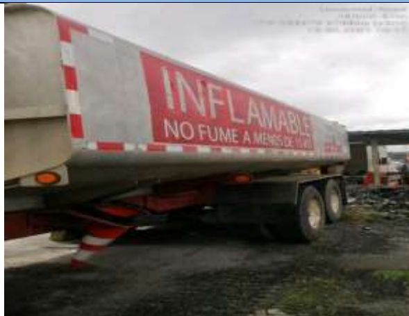
Imagen 182. Camión cisterna sin el rombo de seguridad (978832 N/ 538880 E)
