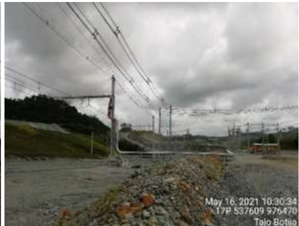
Imágenes 178 y 179. Sistema Trolley instalado en el área del Tajo Botija, para minimizar el consumo de combustible de los camiones de acarreo (976468 N/ 537606 E)
