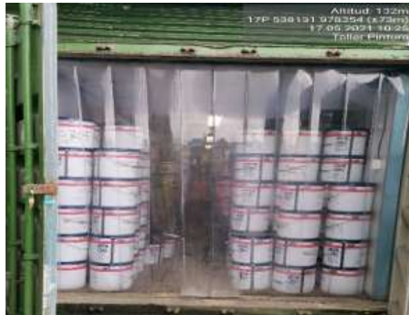
Imagen 225. Almacén de Taller de Pintura sin contención secundaria, ni kit de control de derrames (978353 N/ 538131 E)
