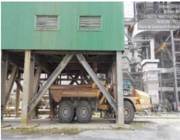
Imágenes 22 y 23. Camión recibiendo las cenizas en el silo de la Planta de Generación Eléctrica para su transporte al Área de Depósito de Cenizas (996929 N/ 533736 E)
