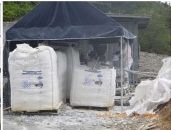
Imágenes 35 y 36. Unidad de dosificación de cal en la Poza de Sedimentación 2 para el control del pH del agua (976358 N/ 537943 E)
