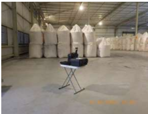
Imágenes 2.1.9 y 2.1.10. Inspección de PM 10 y emisiones gaseosas en Almacén de Nitrato de Amonio (980662 N/ 539263 E)
