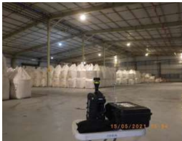
Imágenes 2.1.9 y 2.1.10. Inspección de PM 10 y emisiones gaseosas en Almacén de Nitrato de Amonio (980662 N/ 539263 E)
