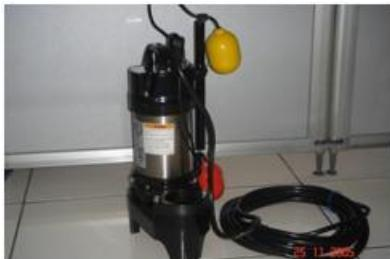
1 Bomba para extracción de lodo en el tanque de lodos.
