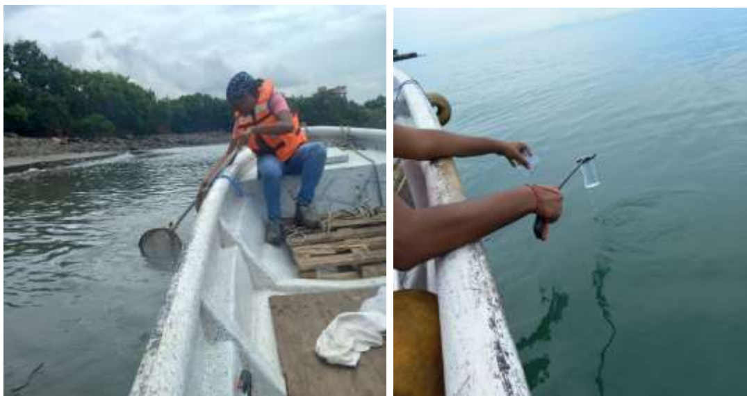
Imagen 53. Colecta de plancton mediante la técnica de arrastre y punto de muestreo
