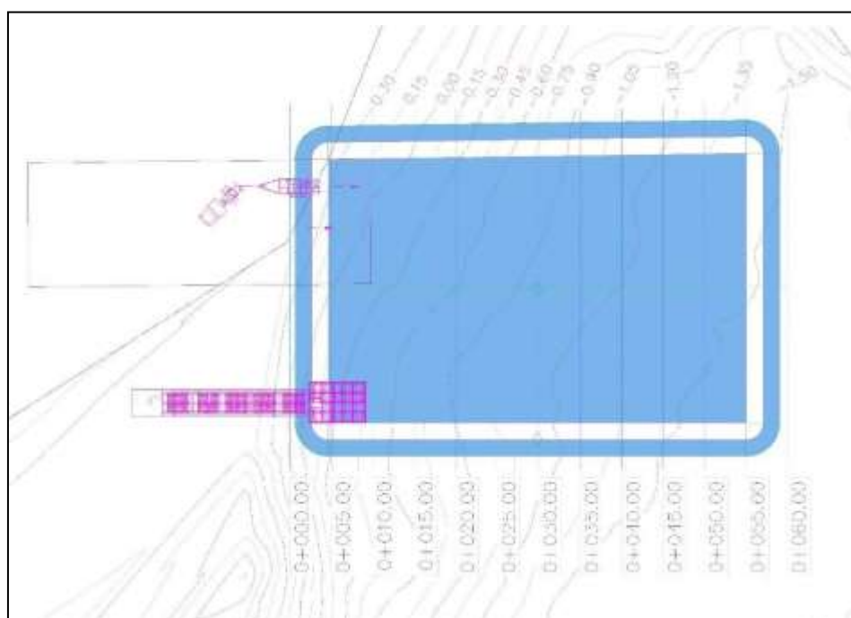
Imagen 18. Zona 2 Ilustración del área de 1,613.86 m 2 y del volumen a dragar de 2,120.90 m 3 .
