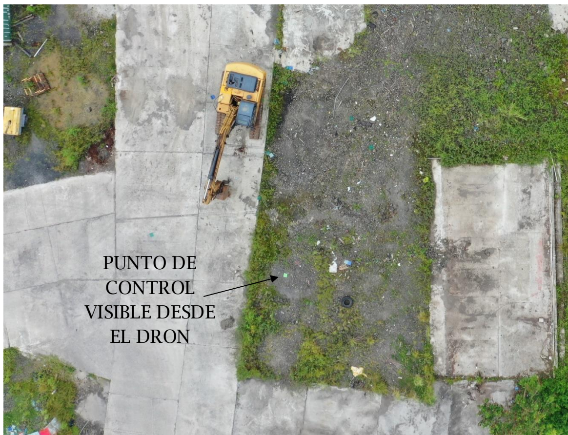
Figura 2: Fotografía con punto de control visible (28/07/22).
