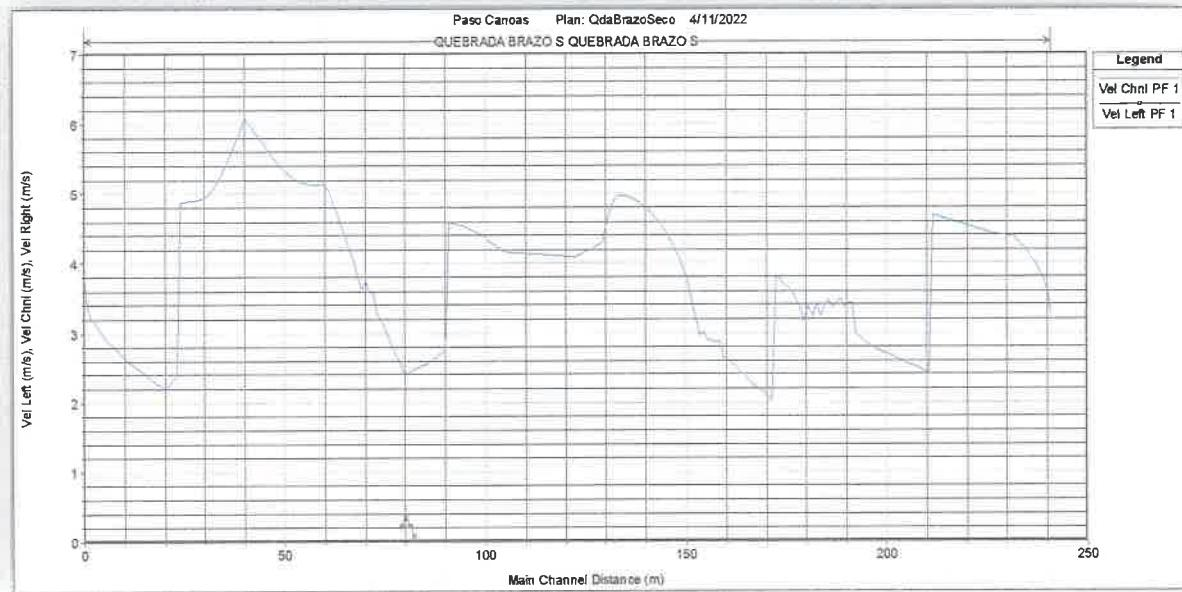
Figura 9 – Perfil de velocidades en el cauce de la quebrada Brazo Seco
