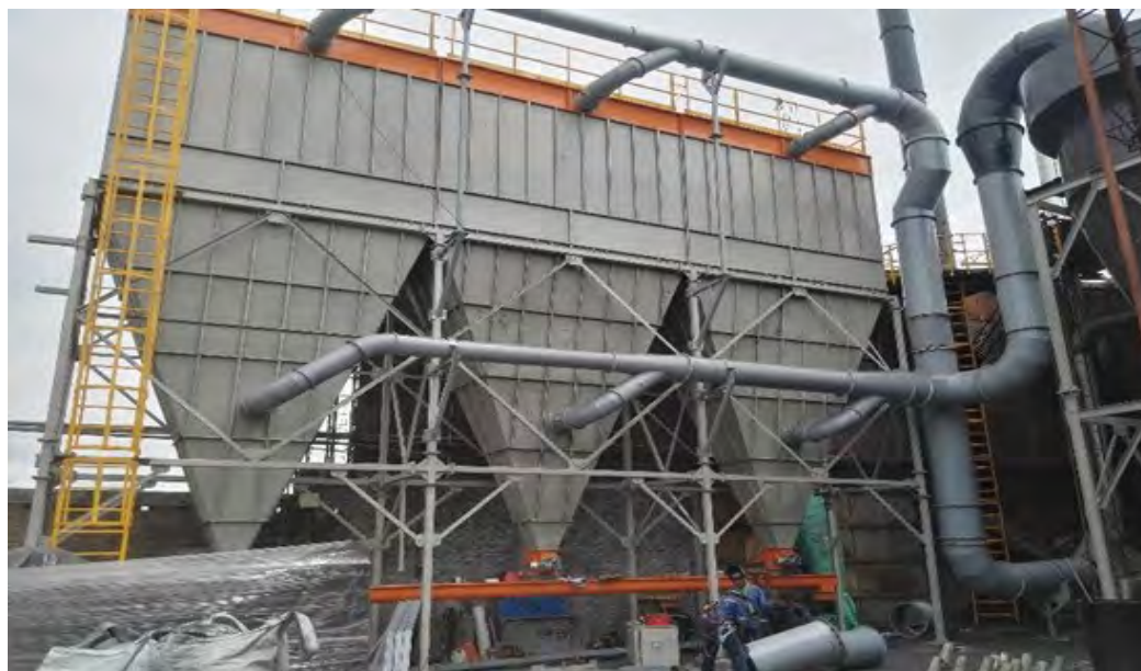
Ilustración N° 29. Sistema de control de emisiones para horno rotatorio. Fuente: Productora Nacional de Metales S.A.S.
