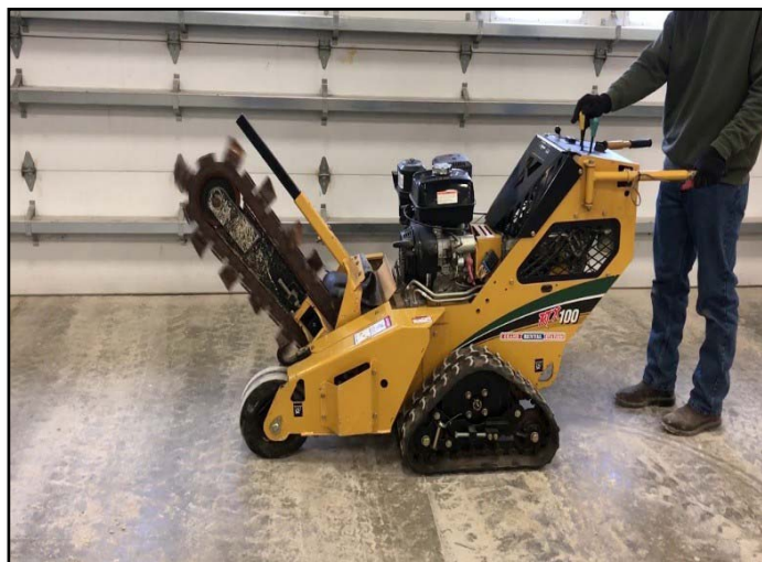
Figura #5 y 6. Vista del equipo a utilizar en el zanjado, de la marca Vermeer, modelos RTX-100 y RTX-250. Fuente: Promotor.
