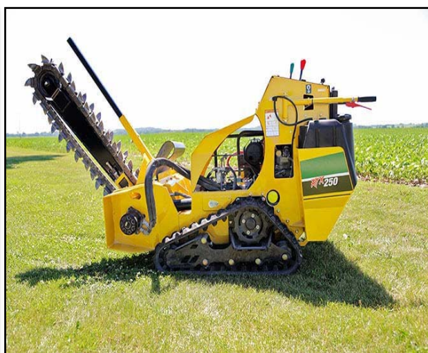
Figura #5 y 6. Vista del equipo a utilizar en el zanjado, de la marca Vermeer, modelos RTX-100 y RTX-250. Fuente: Promotor.
