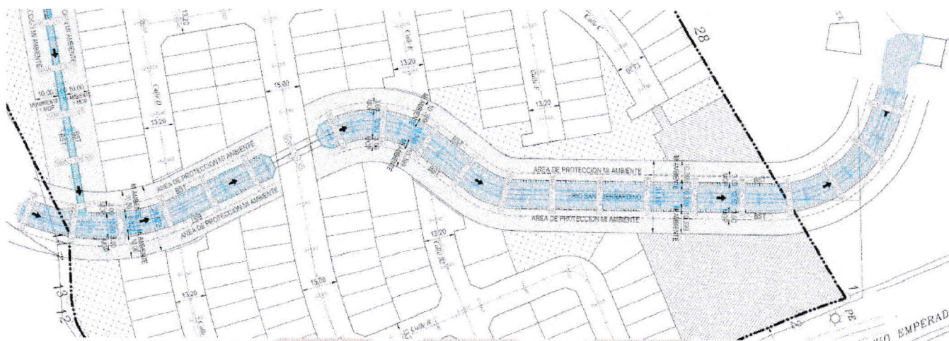
Figura 3. Geometría de la Canalización dentro del Río San Bernardino.
