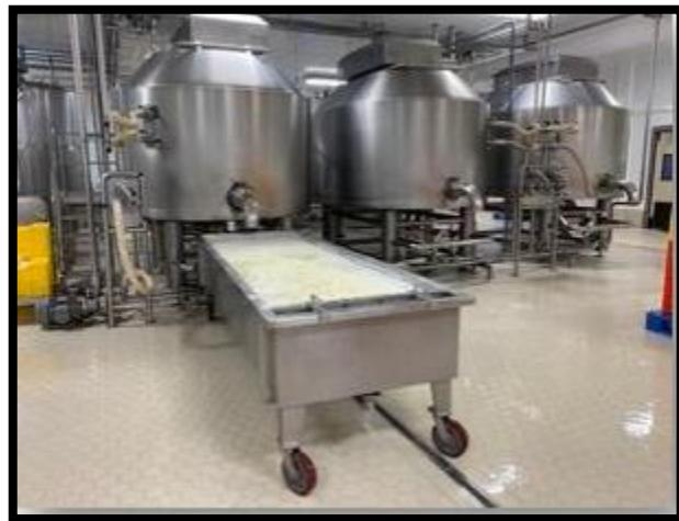
Figura n°4: carro desuerador y tinas dobles
