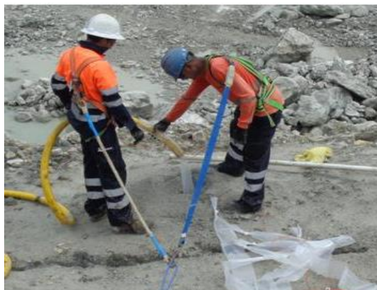
Ingreso de Prima en bolsa de polietileno e Ingreso de bolsa en pozo a cargar
