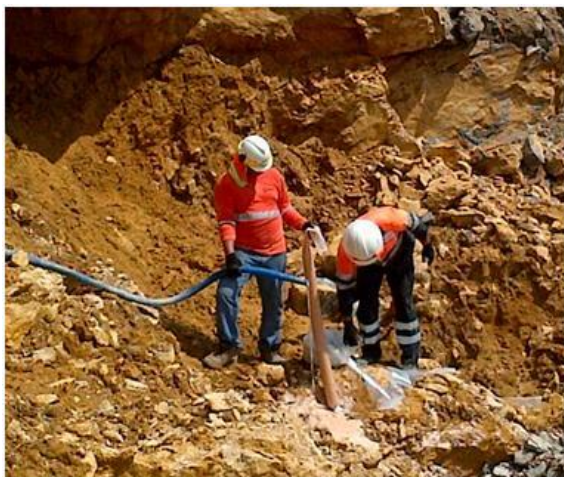
Cargue de explosivo en bolsa de polietileno para pozos en cara libre y con grietas
