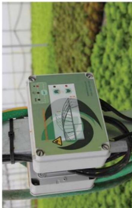
Poder ser ligado a qualquer programador com saída 12-30VDC. Permite fazer o controlo de 96 válvulas. Controla as aberturas superiores das portas. Vártigo: Com este equipamento pode-se controlar aberturas e válvulas. A comutação é contínua e não-latch.
