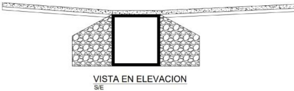
Figura 5. Vista de elevación de alcantarilla de cajón.
