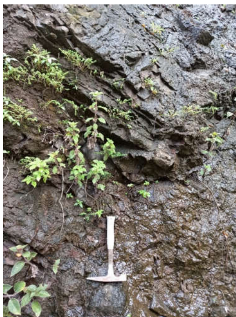
Se aprecia la disposición y persistencia de las diaclasas, como la percolación de agua.
