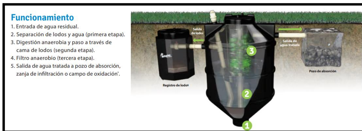
Imagen No.2: Funcionamiento del sistema sanitario (Biodigestor)
