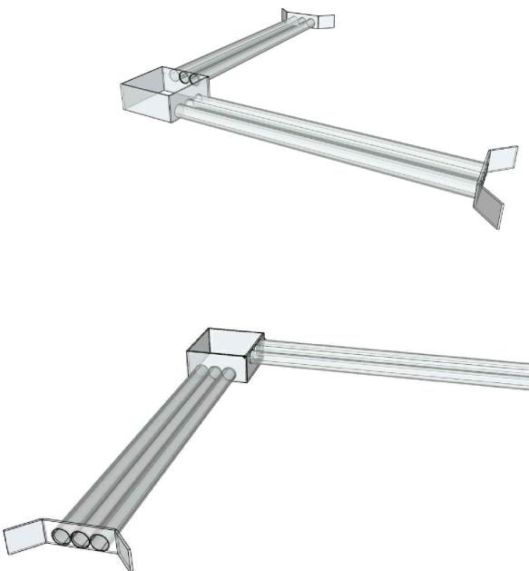
PROPIUESTA DE CANALIZACION ENTUBADA DE LA QUEBRADA CON UN RECORRIDO APROXIMADO DE 155 METROS LINEALES EN TRES TUBERIAS DE 2.10 DE DIAMETRO INTERNO EN CONCRETO REFORZADO Y CAJONES DE DESVIO DE HORMIGON REFORZADO
