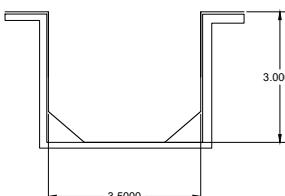
PROPIUESTA DE CANALIZACION A CIELO ABIERTO CON UN RECORRIDO APROXIMADO DE 200 METROS LINEALES EN UN CANAL DE 3.50 DE ANCHO INTERNO Y 3.00 METROS DE PROFUNDIDAD DE CONCRETO REFORZADO., CON DESCARGA AL RIO EN UN CABEZAL DE REFUERZO Y UN MANTO DE ZAMPEADO DE PIEDRA CON CONCRETO
