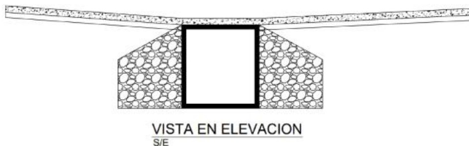
Figura 5. Vista de elevación de alcantarilla de cajón.
