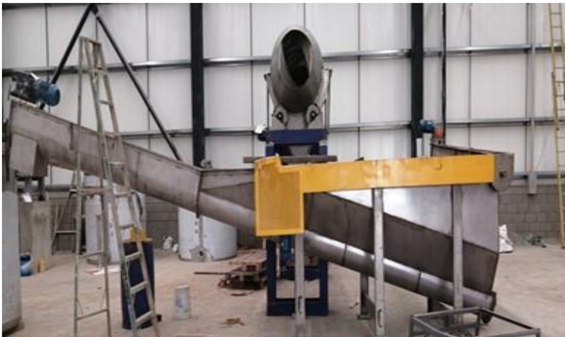
Ilustración: Tanque separador de Plomo y plástico.
