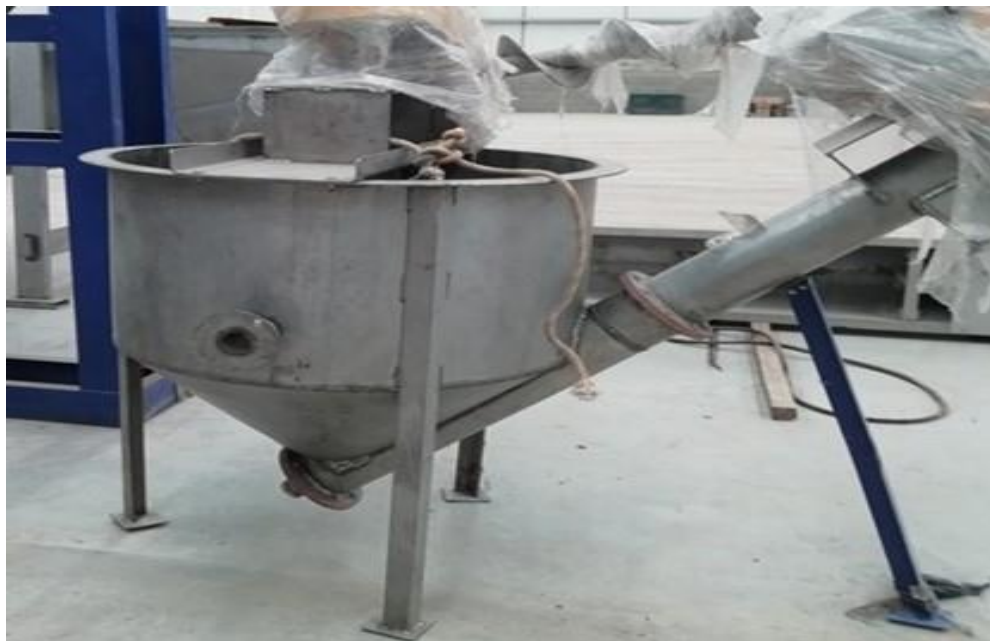
Ilustración: Separador de metálicos finos, ácidos y lodos.
