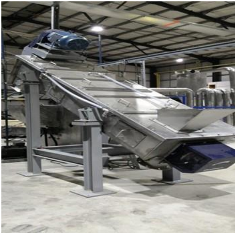
Ilustración: Lavadora de fricción 50/300, Rotor inox, 30 hp, 440 v.
