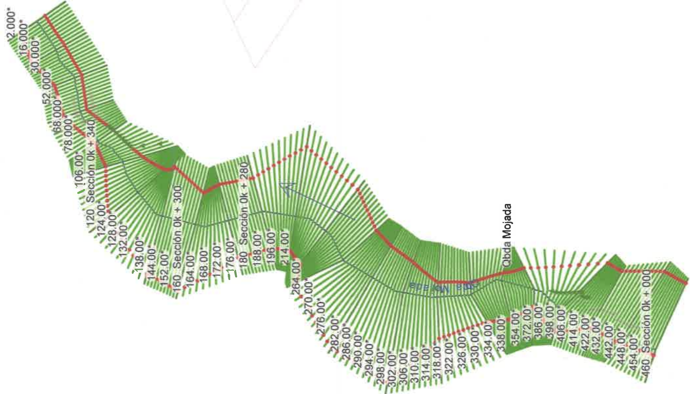
Figura 8. Vista de la topografía de cauce de quebrada Mojada, ya ingresada en el programa HEC-RAS, a partir de las secciones transversales originales de la topografía y posterior proceso de generación de secciones transversales interpoladas a cada 2 metros e inclusión de vado temporal de alcantarilla.
