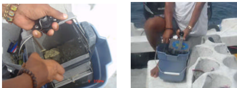
Figura No. 7c: Toma de muestras de sedimento, Draga Ekman
