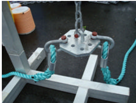
Fig. 5.5.12. Ejemplo de una conexión en una esquina del enrejado con plato y líneas de poli acero. El compensador de sub superficie flotante se ata a la parte superior, el bloque de lastre al fondo y las líneas de ancla, de enrejado y jaulas a los lados.
