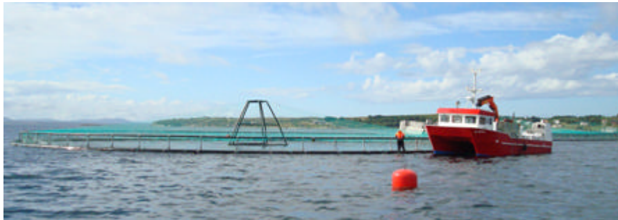
Fig. 5.5.8. Red Aqualine de superficie de 50 m de diámetro en operación fuera de las costas de Noruega.
