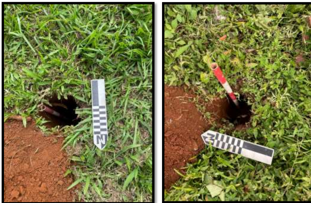
Fotografías 23 y 24: sondeos realizados en los sectores del tramo 3. Nótese el alto grado de alteración del sustrato
