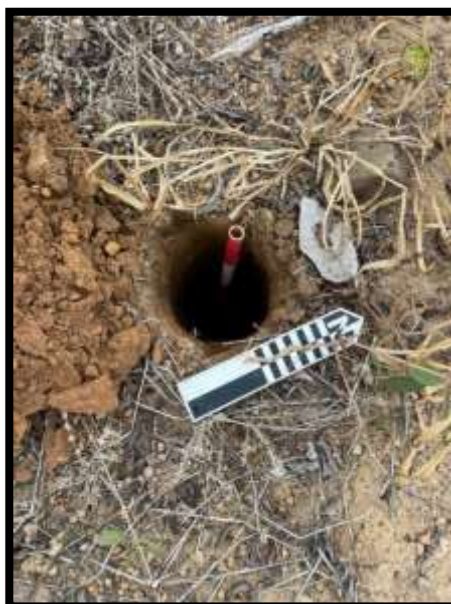
Fotografías 11 y 12: sondeos realizados en los sectores del tramo 2. Nótese el alto grado de alteración del sustrato
