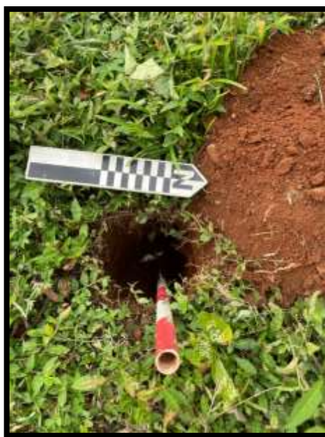
Fotografías 19 y 20: sondeos realizados en los sectores del tramo 3. Nótese el alto grado de alteración del sustrato
