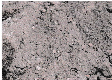
Grava arenosa de color color chocolate claro a gris de formación compacta
