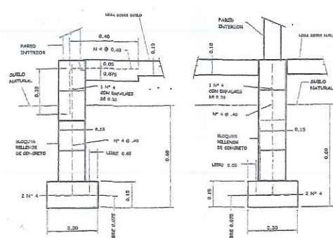
SECCIONES TRANSVERSALES EN CIMIENTOS DE PAREDES S/E
