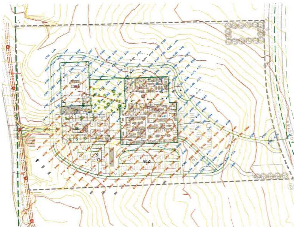
PLANTA DE CORTE Y RELLENO ESC. 1:500
