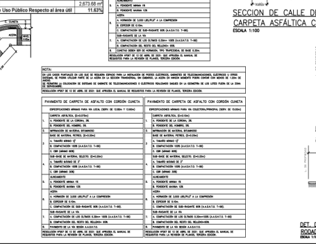
PLANTA DE CALLE Y ACERAS VIA LOCAL (SECCION DE 13.60m) PAVIMENTO DE CARPETA DE ASFALTO CON CORDON CUNETIA ESCALA 1:100
