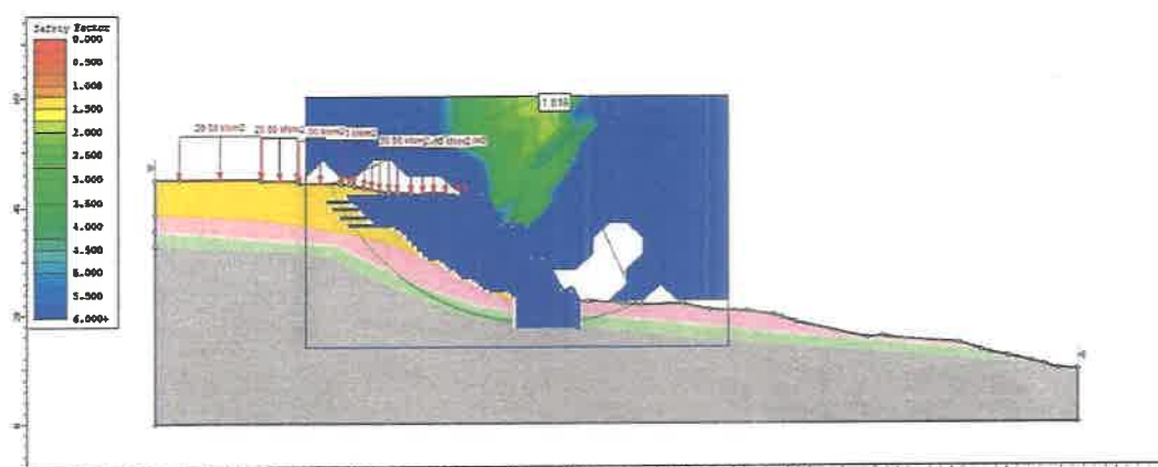
Figura 22 Análisis de estabilidad rellenos (análisis B en falla rotacional) - condición estática mejoramiento en granular
